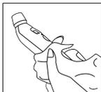
La funda del termómetro puede limpiarse con soluciones de cualquier desinfectante que cuente con la aprobación del hospital, de alcohol e incluso de lejía. Evite los productos de limpieza ásperos o abrasivos, ya que pueden rayar el termómetro.
